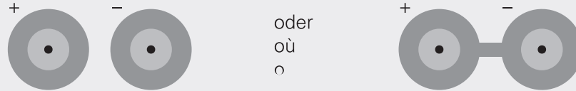
7.12.5 Figure 8: Câble monoconducteur ou multiconducteur
